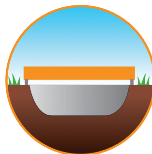
Určena pro zapaštění do země, skákací plocha je na úrovni povrchu
